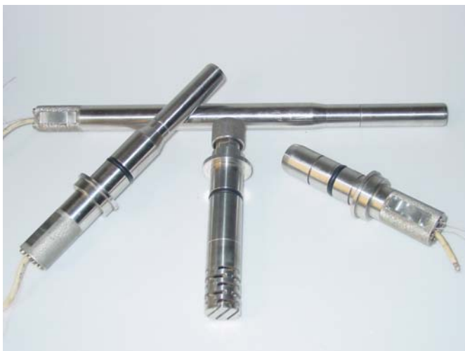
Рис. 3.6. Внешний вид стерилизуемых амперометрических сенсоров АСрН 2 -06.
