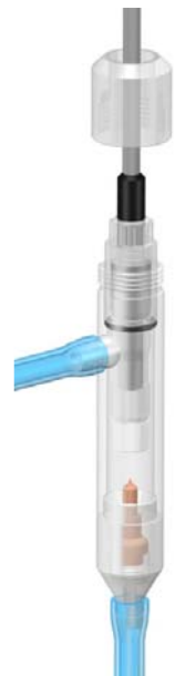
Рис. 3.10. Фиксация АСрН 2 в измерительной камере
